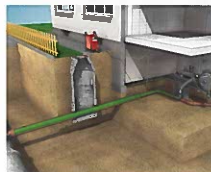
Nach dem Aushärten ist ein neues Rohr im Altrohr entstanden.
